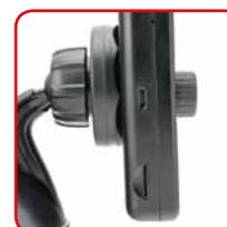
Verbindungen von oben nach unten: DC-Micro-USB, MicroSD
